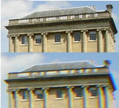
Tritt durch Abbildungsfehler optischer Linsen auf. Linsen haben unterschiedliche Brechzahl für Licht unterschiedlicher Wellenlänge (z.B. Blau hat kürzere Brennweite als Rot). Dadurch kann es passieren, dass diese Farbanteile sich relativ zum eigentlichen Ursprung verschieben. Wird besonders sichtbar an Kanten mit harten Farbübergängen.
